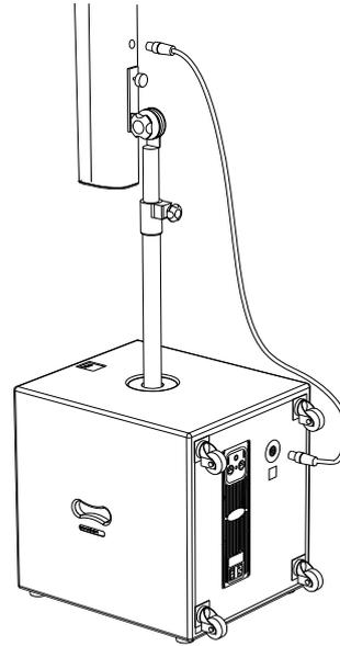
Collegate K4m Top con K4m Sub per mezzo dell'apposito cavo di collegamento. Inserire una estremità del cavo nella presa posta nella parte posteriore di K4m Top. Inserite l'altra estremità nella presa TOP OUT del pannello connessioni situato nella parte posteriore di K4m Sub. Inserite i connettori fino in fondo e poi ruotateli in senso orario fino a sentire uno scatto che ne assicura il bloccaggio.
