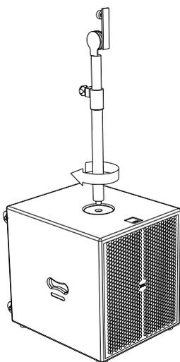
Prendete lo stativo di collegamento e avvitatelo nel foro posto sulla parte superiore del subwoofer
