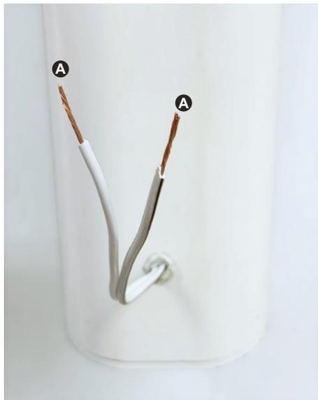
Collegare le estremità dei cavi in uscita (A) con il sistema di amplificazione. Identificare le polarità dei cavi in uscita seguendo il seguente schema: Cavo Bianco/Nero => Polarità negativa; Cavo Bianco => Polarità positiva.
